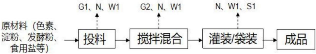
图7 炸粉生产工艺流程图
